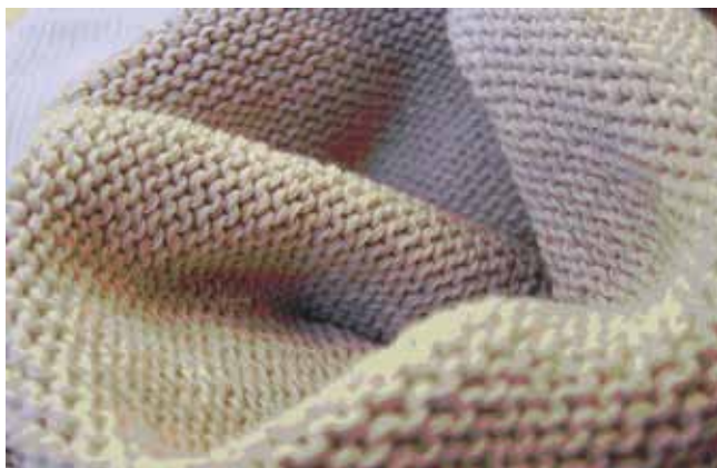
Радиозащитная хлопчатобумажная ткань с НФМП NFM radar screen cotton fabric
