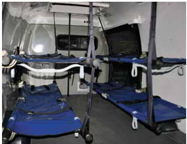
Обнащение автомобиля «Соболь» военного для перевозки раненых / Equipment for Sobol Military Vehicle for Transportation of the Wounded
