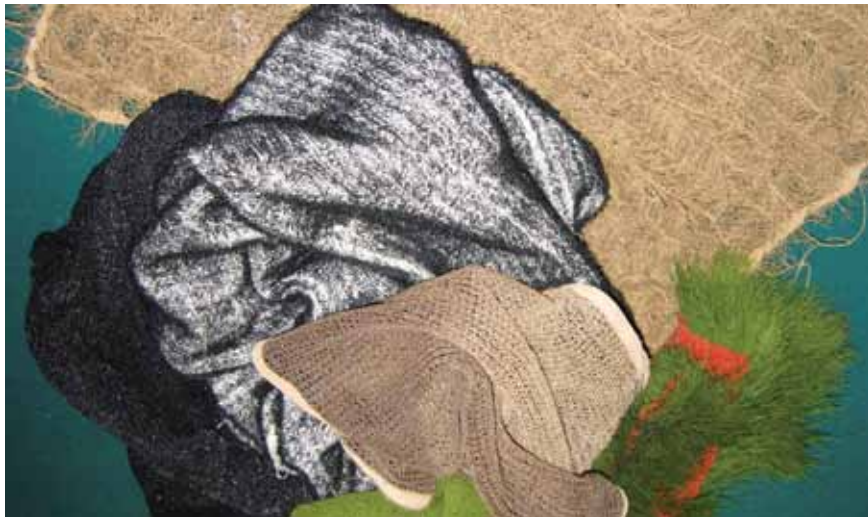
Радиопоглощающие и радиозэранирующие ткани на основе наноструктурного ферромагнитного микропровода Radar absorbent and screen fabrics based on nanostructural ferromagnetic microwire
